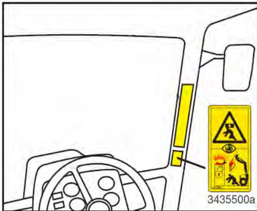
**Vor jeder Benutzung des Frontladers durch Sichtkontrolle der Schalterposition der Betätigungsbox und sichere Befestigung des Arbeitswerkzeuges an der Schwinge überprüfen. Der Sicherheitsaufkleber (3435500a) muß in der Kabine angebracht sein, um den Fahrer vor dieser Gefahrsituation zu warnen.**
