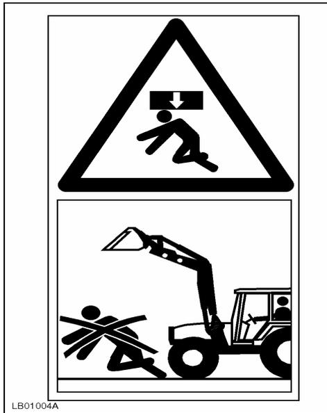
10. Der Aufenthalt von Personen in der Nähe des Arbeitsbereichs des Laders (3m) ist streng verboten. Halten Sie sich nicht in der Nähe von angehobene Frontladern oder ungesicherten Last auf. Beachten sie bitte besonders die Vorschriften zur Maschinen-Sicherheit bei Frontladerarbeiten nach DIN EN 12525/A1:2006.
